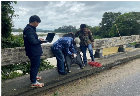
ภาพที่ 5.1-2 การสำรวจปริมาณน้ำที่สถานี X.228 แม่น้ำตรง บ้านกลาง อำเภอมือง จังหวัดตรัง ตารางที่ 5.1-1 ข้อมูลการสำรวจปริมาณน้ำที่สถานี X.228 แม่น้ำตรง บ้านกลาง อำเภอมือง จังหวัดตรัง
